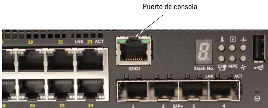
Ilustración 1-9. Panel frontal de N1524P con puerto de consola
