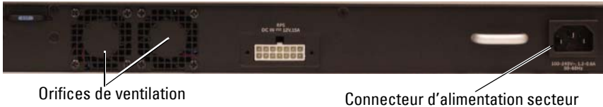
Figure 1-4. Panneau arrière de la série N1500
